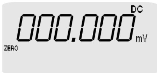
Das Gerät quittiert die Nullpunkteinstellung mit einem Signalton und auf der LCD werden „000.000“ ( $\pm 1$  Digit) und das Symbol „ZERO“ angezeigt. Die im Augenblick des Drückens angezeigte Spannung dient als Referenzwert (max.  $\pm 20000$  Digit). Er wird von den danach gemessenen Werten automatisch abgezogen.
