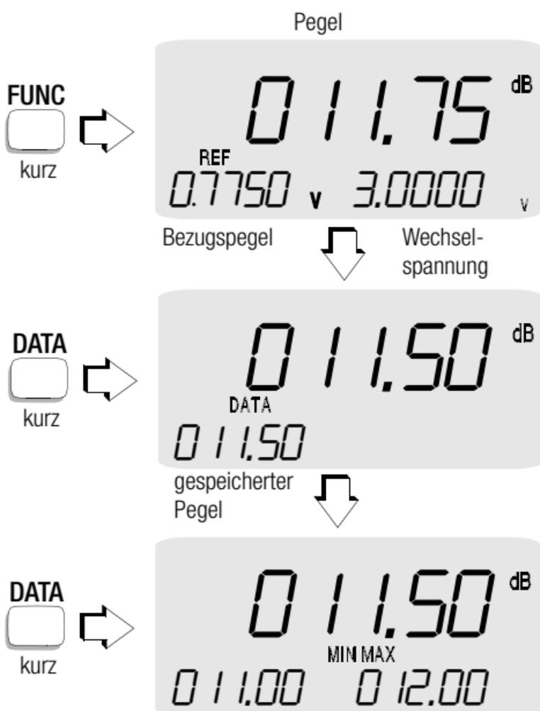
Die an den Buchsen anliegende Wechselspannung wird in der Nebenanzeige rechts eingeblendet.
