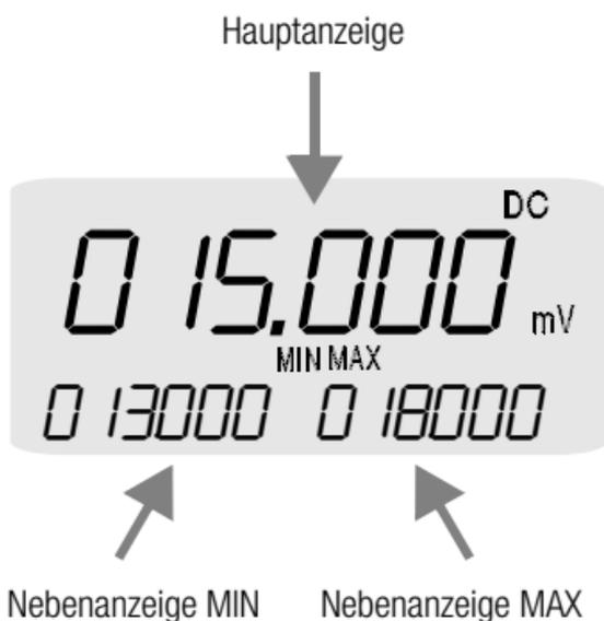
Während die Hauptanzeige unmittelbar nach dem Einschalten des Multimeters erscheint, müssen die beiden Nebenanzeigen durch Betätigen der Taste DATA/CLEAR aktiviert werden. Hierdurch wird vermieden, dass ein zu Beginn der Messung vorhandener (undefinierter) Zustand, z.B. ein Leerlauf, ständig als Maximalwert eingeblendet wird.
